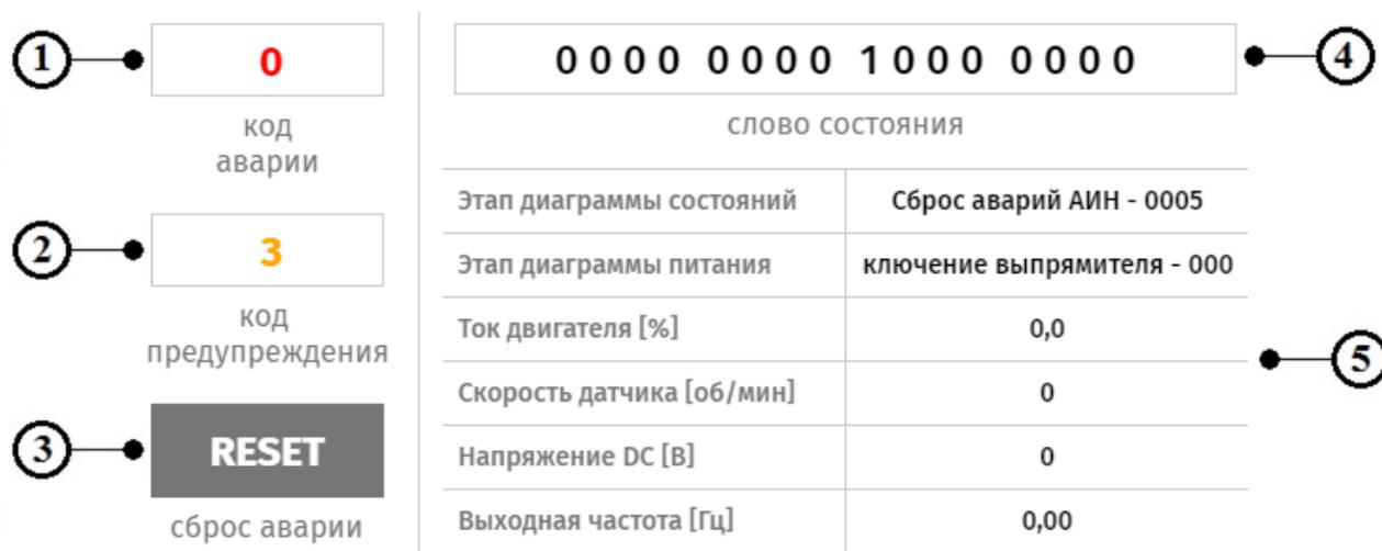
Рисунок 11. Вид области текущего состояния привода в составе панели управления СПО
